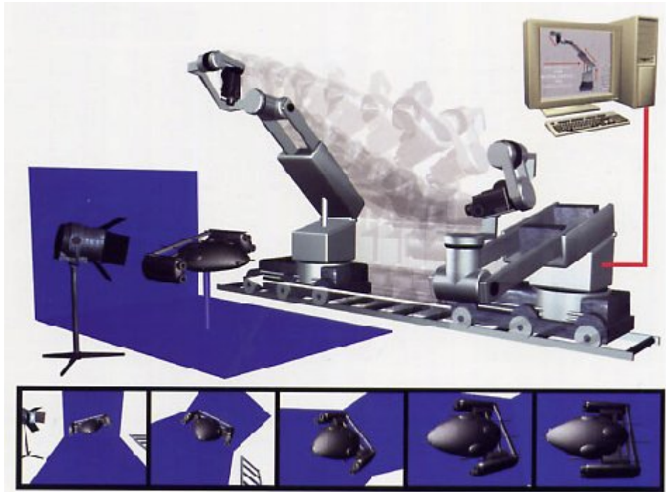
Figura XI: sistema para movimentação de câmera, controlado por computador 15
