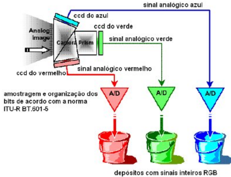
Figura III: separação das cores na câmera digital de 3 CCDs 7 .
