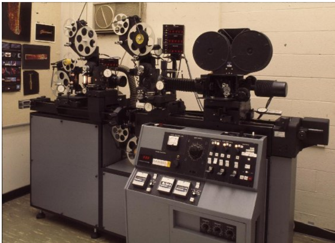
Figura 1: impressora ótica Oxberry2.
